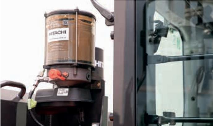
Die Zentralschmieranlage trägt zur Senkung der Wartungskosten bei.
