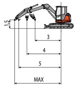
Hebekraft basierend auf ISO-Norm 10567 und überschreitet nicht mehr als 75% der Kippplast oder 87% der hydraulischen Hebe-Kapazität der Maschine.
